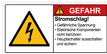
Abb.: Warningschild – Aufbau nach ANSI-Vorgaben führt zu wirkungsvoller Warnung
